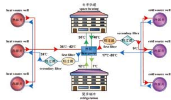
● 天津市古文化街地热利用工程工艺流程示意图
