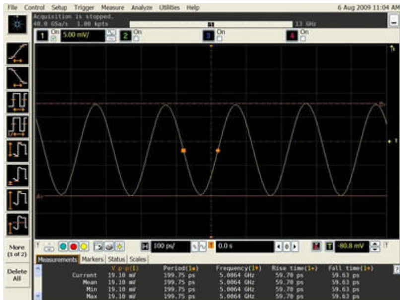
图 2 频率控制字为 128 时 DDS1 芯片的输出波形 (5GHz 正弦波)
